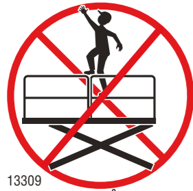
13309 KLATRING PÅ REKKVER- KET ER FORBUDT
